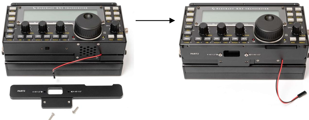
10、取PART3铝合金配件，用两颗M3\*5mm的内六角螺丝，将PART3紧固于PART2上。
