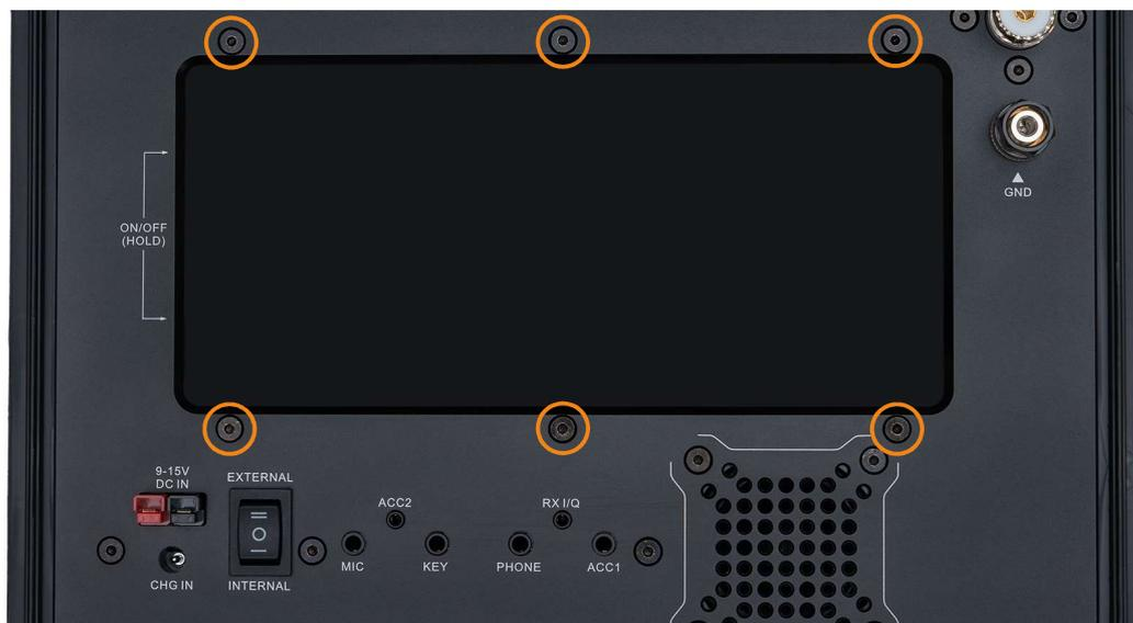
3、依次拧下KX3电台主机左侧板、右侧板上的手拧螺丝，并将手拧螺丝和脚架取下。
