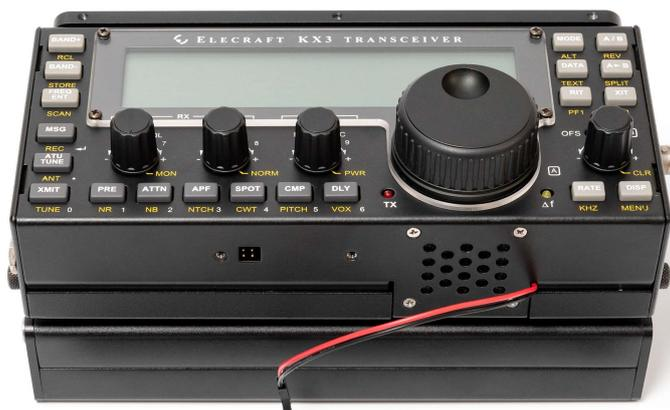
9、取PART2铝合金配件，用两颗美规4-40\*1/2螺丝将PART2紧固于KX3电台。
