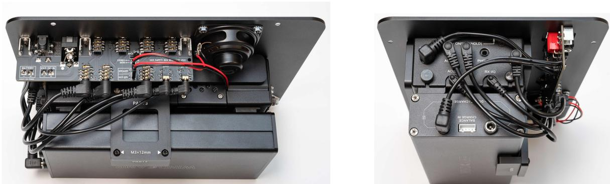
17、取射频转接线，将KX3电台主机天线端口，与安全箱面板的天线端口进行连接。
