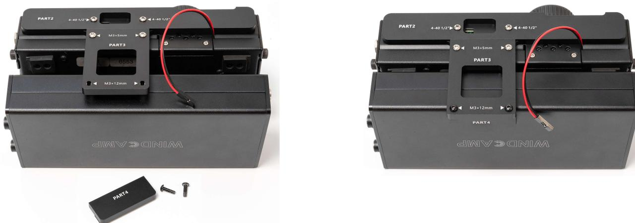
12、将KX3电台主机安装至安全箱面板。安装螺丝为M3\*8mm的黑色内六角沉头螺丝共6颗。
