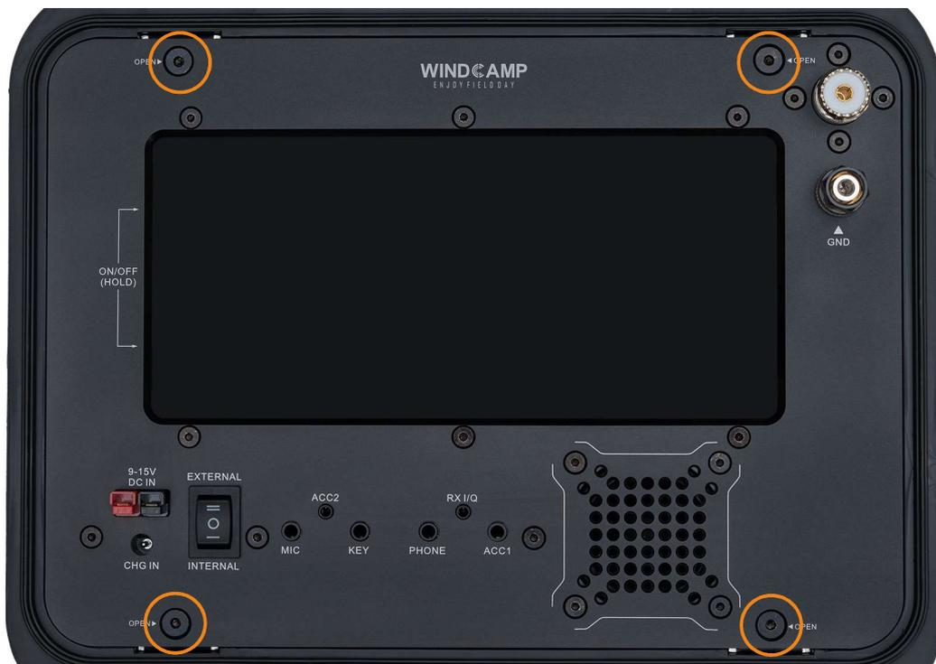
2、用M2内六角扳手，拆卸下图红圈中的六颗M3内六角螺丝，即可将内部的PART1、PART2、PART3、PART4铝合金配件拆下。拆卸后的配件及螺丝，请妥善放置稍后备用。
