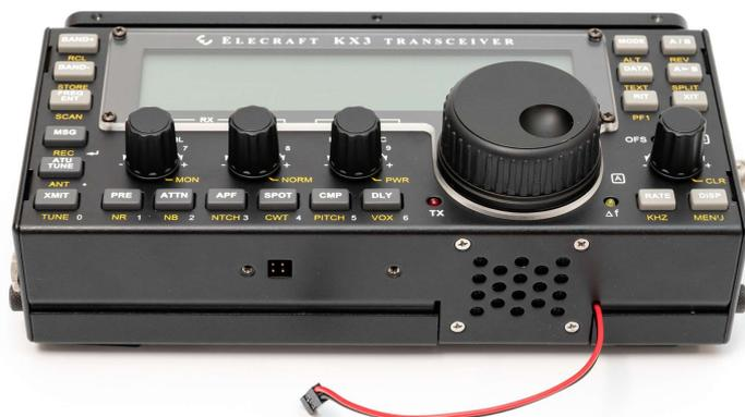
9、取PART2铝合金配件，用两颗美规4-40\*1/2螺丝将PART紧固于KX3电台。
